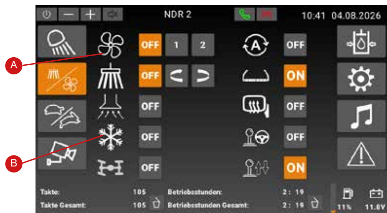
Abb. 17. Steuerung Belüftung / Anbaugeräte
