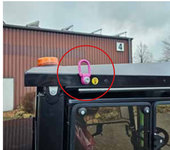
Abb. 43. Kranöse hinten rechts
