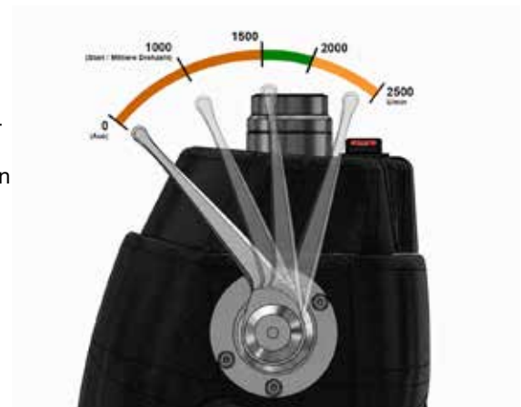
Abb. 19. Schematische Darstellung Drehzahl-Verstell-Hebel
